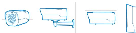
L'AromaGuard peut être installé de quatre façons différentes. (sur pied, bras directionnel, mur vertical et encastré)
